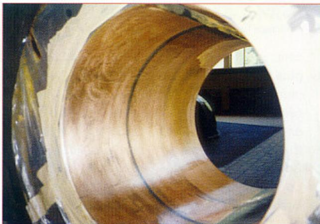
L'arbre et le tourteau du rotor d'alternateur : hauteur 700mm - Ø 500 mm, profondeur plusieurs dixièmes de mm - Délai : moins d'une semaine.
