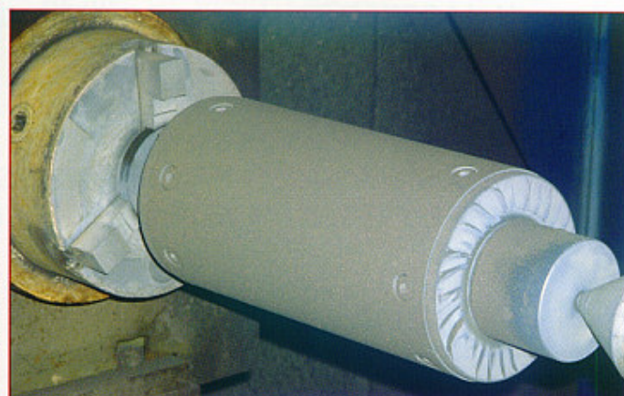
Pièces revêtues de carbure de tungstène
