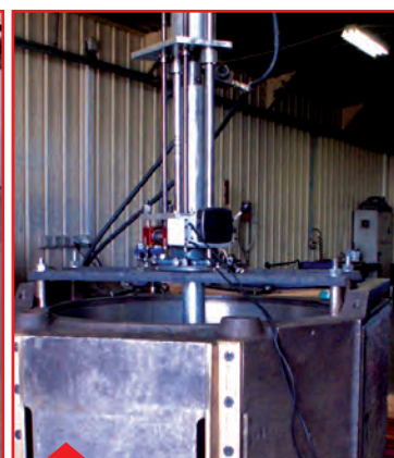
Usinage d'une empoise avec une machine portative
