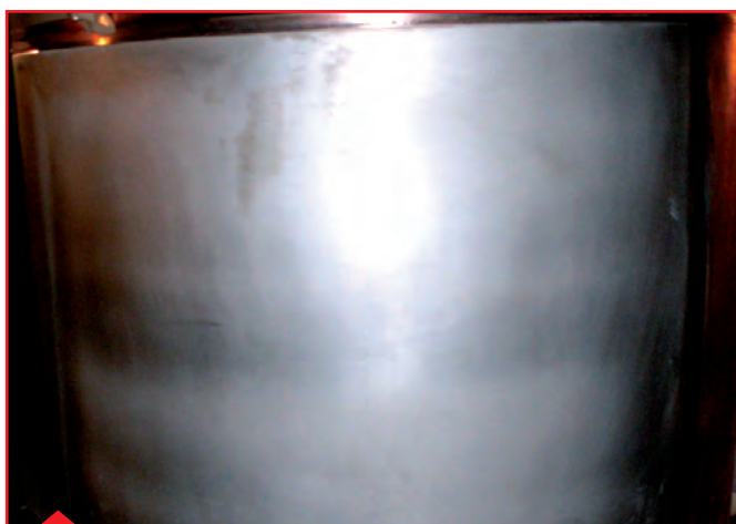
Soie de palier après métallisation électrolytique et usinage
