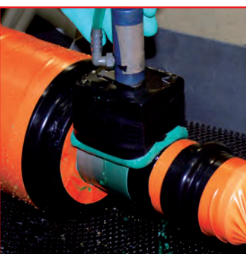
Portée de roulement en cours de métallisation électrolytique
