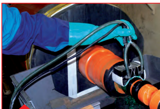
Portée de roulement en cours de métallisation électrolytique
