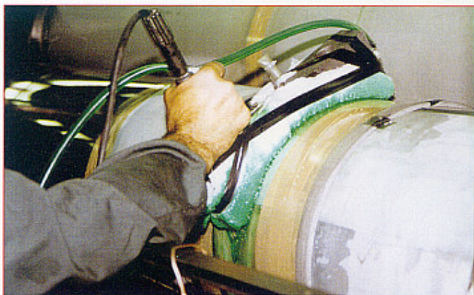
Opération de nickelage par électrolyse au tampon Nickel plating using the brush plating technique
