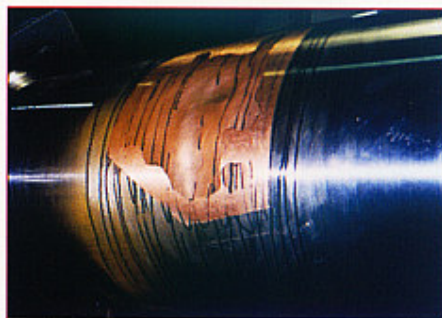
Gros plan sur la réparation après une rectification intermédiaire
